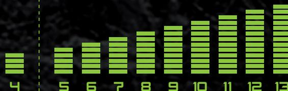
La regolazione del livello di protezione imposta automaticamente il livello di protezione adeguato in un range da 5 a 13. A tale scopo è previsto un ulteriore sensore di luminosità che rileva l'intensità dell'arco di saldatura. Così rimanete sempre perfettamente protetti indipendentemente dai parametri attualmente usati per saldare. Eventuali interventi manuali non sono più richiesti, ma naturalmente sempre possibili premendo un pulsante.
